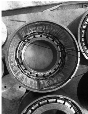
图 19 轴承外圈损伤示意图
